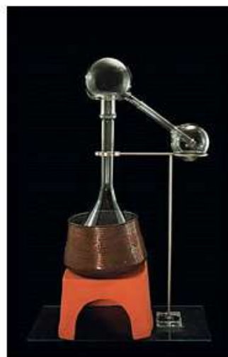
تصویر ۳: مدل تقطیر تکامل‌یافته گلاب، براساس ابوبکر رازی (سزگین، ۲۰۰۳: ۱۱۶). Fig. 3: An Evolved Model of Rosewater Distillation Based on Abū Bakr al-Rāzī (Sezgin, 2003: 116).
